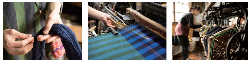
縦糸を整形し、織機で生地を織る。織機は現在 22 台稼働。機械は既に生産されていないので、修理には工場に残る古い機械の部品を使うなど工夫を凝らしています
